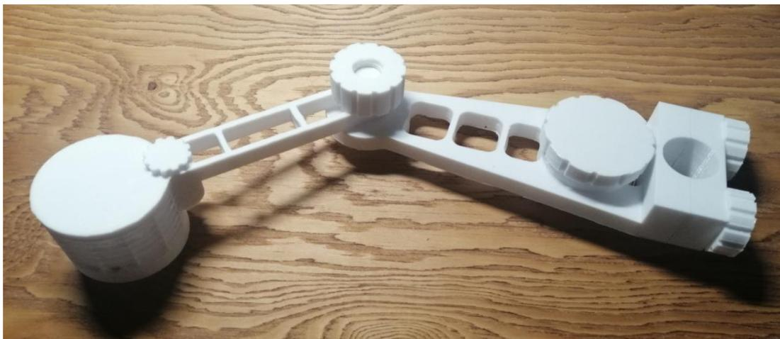
**Рисунок 5 - Радиационный экран для агрометеостанции**
